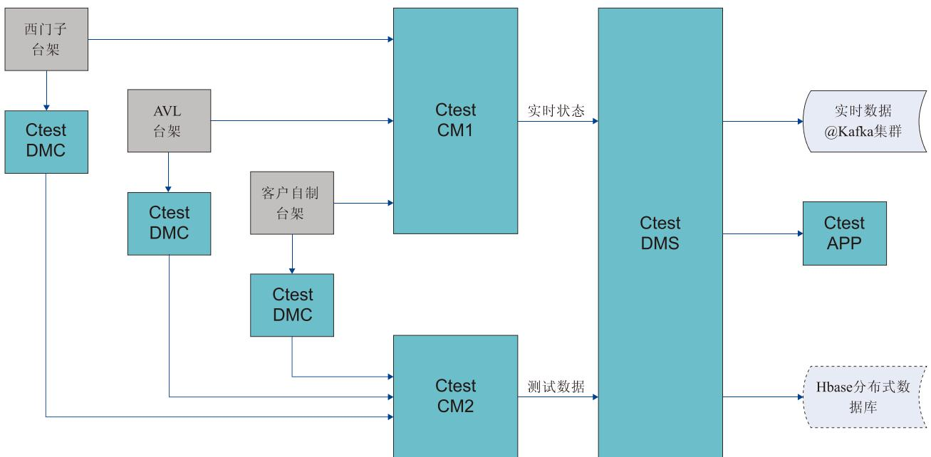
适用于试验中心多台试验设备的实时状态和试验数据的集中监控与管理，同时具有试验流程管理、试验档案管理、DVP过程管理、设备管理、样品管理、计量器具管理等功能。
